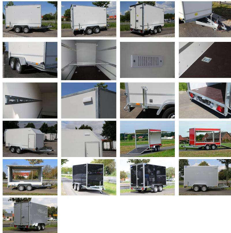
Außenmaße des Koffers mit Heckklappe: L: 460cm x B: 202cm x H: 233cm
