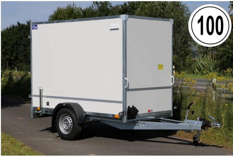
Außenmaße des Koffers mit Heckklappe: L: 420cm x B: 184cm x H: 235cm
