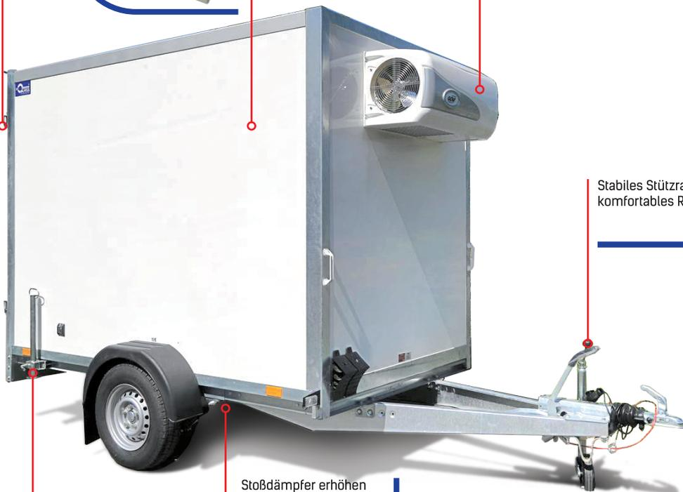
Massive Heckstützen für hohe Standfestigkeit des Anhängers
